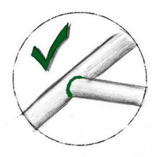
CONTINUOUS WELD ALL THE WAY AROUND THE JOIN
